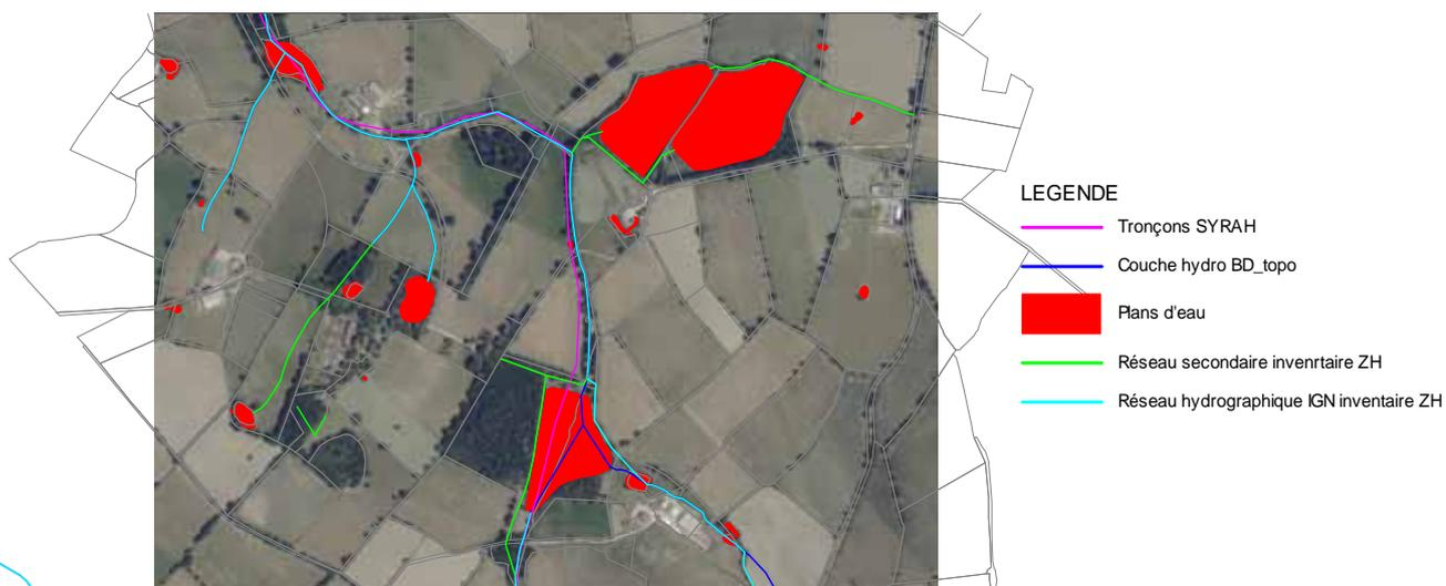
Figure 8 : exemple de superposition des polygones « plans d'eau » et des couches du réseau hydrographique sur la commune de la Peyratte
